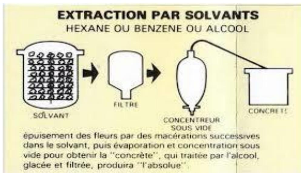
**Figure 17 :** Technique d'extraction par solvant.
