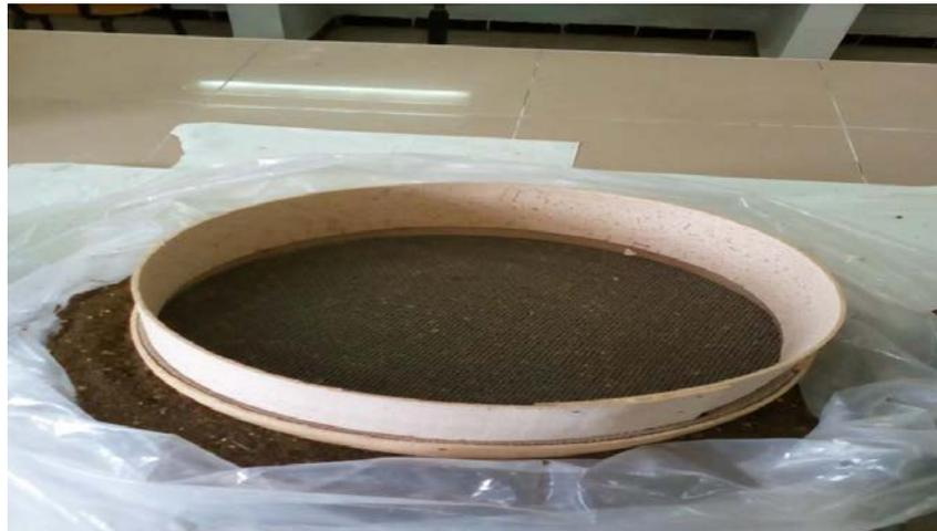
**Figure N°24:** tamisage du sol par un tamis à mailles carrés de 1 mm de diamètre
