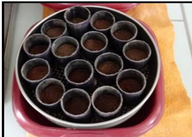
Figure N° 18 : Essai de la capacité de rétention.
