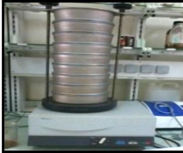
Figure N°14: Tamis mécanique
