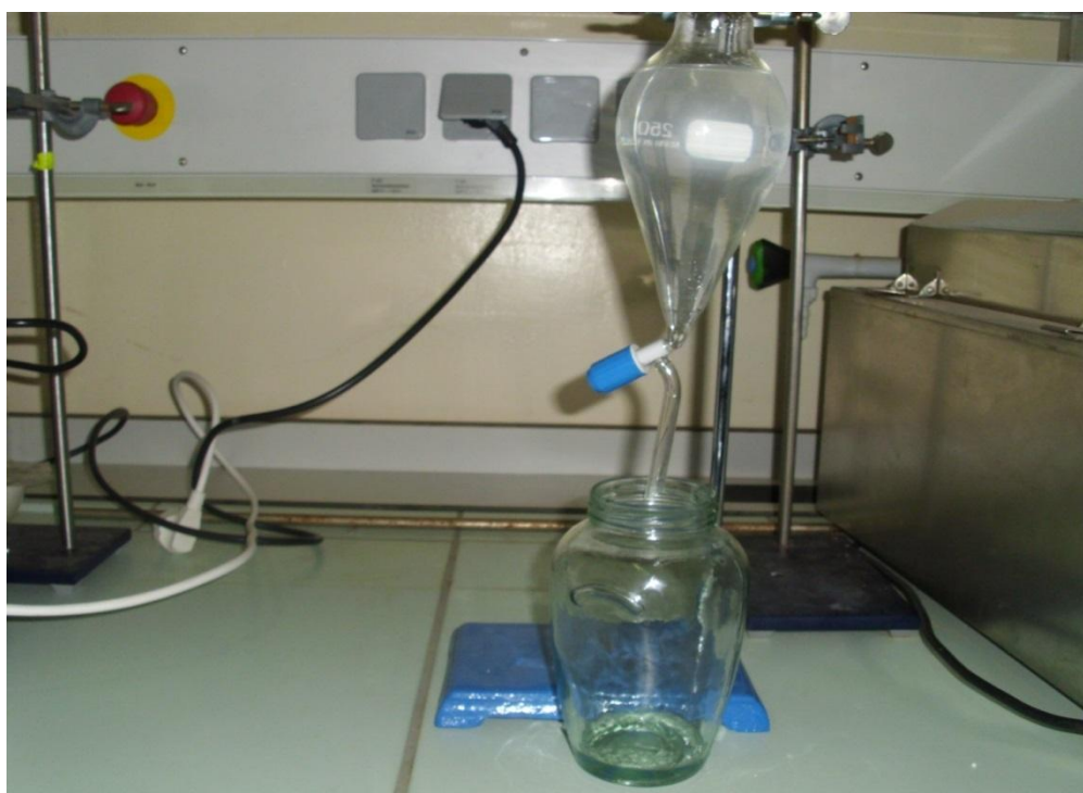
Figure N° 23 : la phase de séparation d'huile essentielle de l'hydrolat
