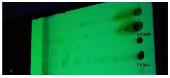
**Figure n°47:** Séparation des extraits de la coloquinte sur plaque CCM. Au système bénzene/ acétate prises après révélation à la lumière UV à 366 nm
