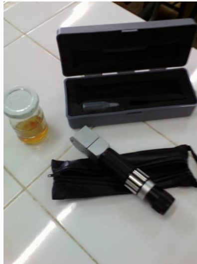
Figure 18 : un réfractomètre pour mesurer la teneur en eau.
