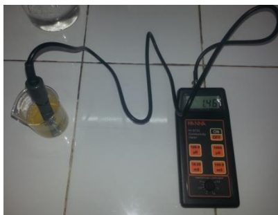
Figure21 : détermination de la conductivité mètre d'une solution du miel.
