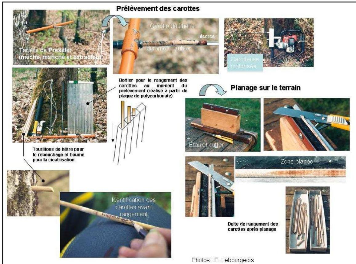
Figure 11 : Les étapes d'analyses des éprouvettes de sondages de croissance (Lebourgeois).
