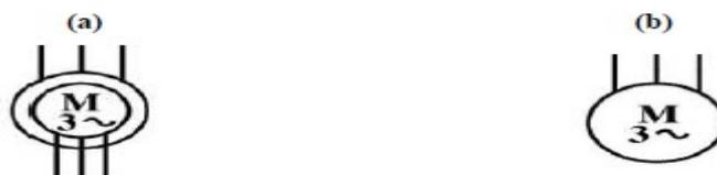
Figure 18 : Symboles électrique du moteur asynchrone à rotor bobiné (a) et à cage d'écureuil (b).
