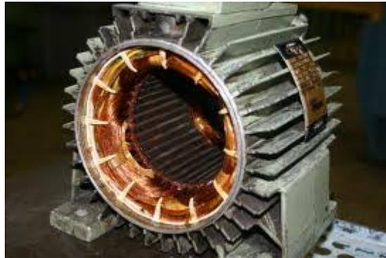
Figure 17 : Stator d'un moteur asynchrone
