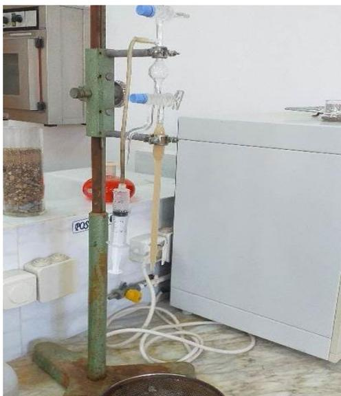
**Figure19** : prélèvement de 10 Cm par la pipete de robinson
