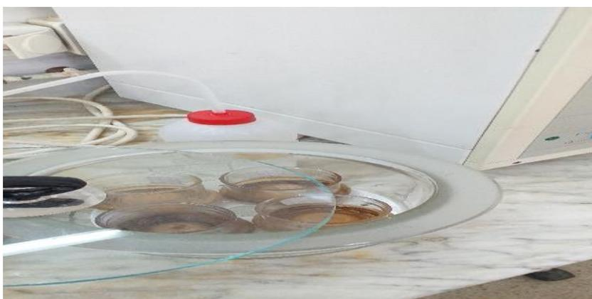
**Figure20** : capsules de prélèvements après le séchage
