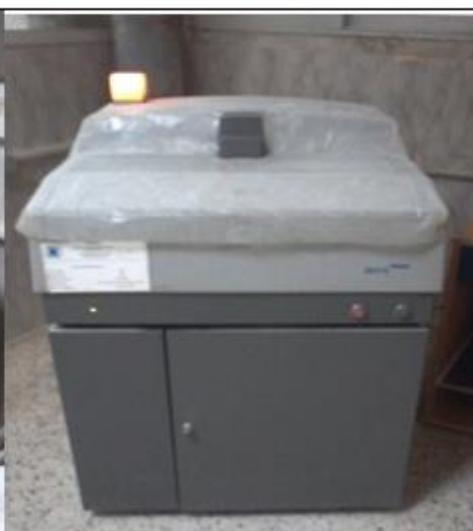
**Figure 25:**analyseur par fluorescence X.
