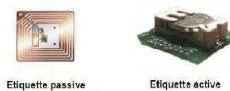
Figure 24: Les étiquettes RFID [28].
