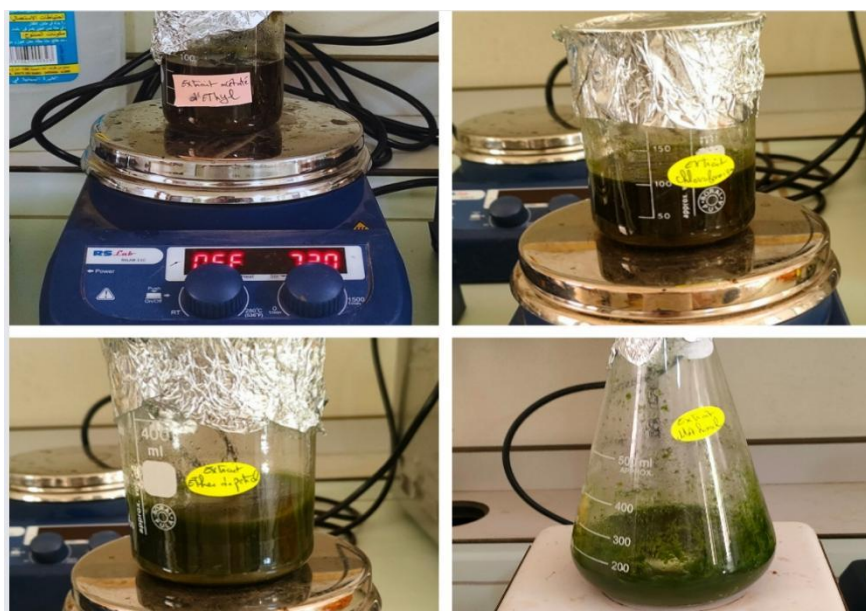
Photo 03 : La macération des extraits sous agitation magnétique.
