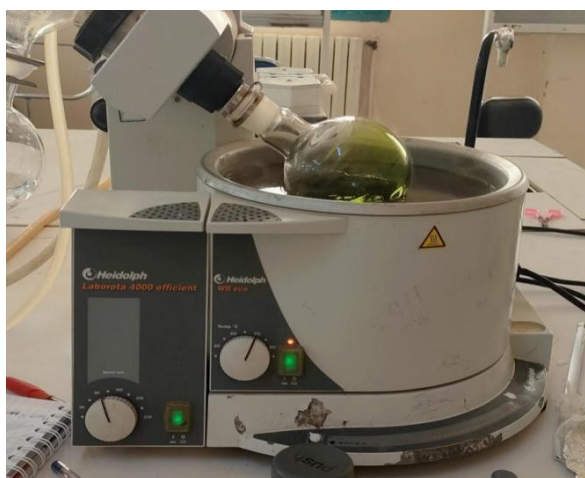
photo 05 : Rotavapor utilisé pour obtenir l'extrait brut de M. vulgare
