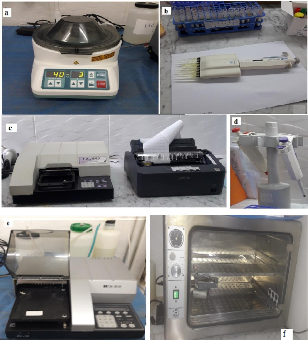
**Photographie 01** : Matériels utilisés. **a**: centrifugeuse du sang, **b**: pipette multicanaux, **c** : lecteur et imprimante, **d** : pipette, **e** : laveur, **f** : incubateur.
