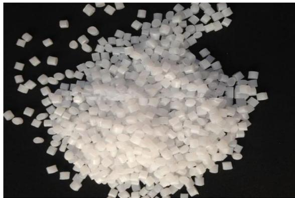
**Figure 10:** Photos polystyrène choc.
