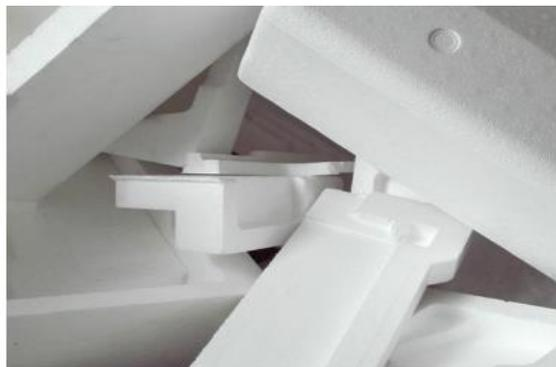
**Figure 11:** Polystyrène expansé moulé
