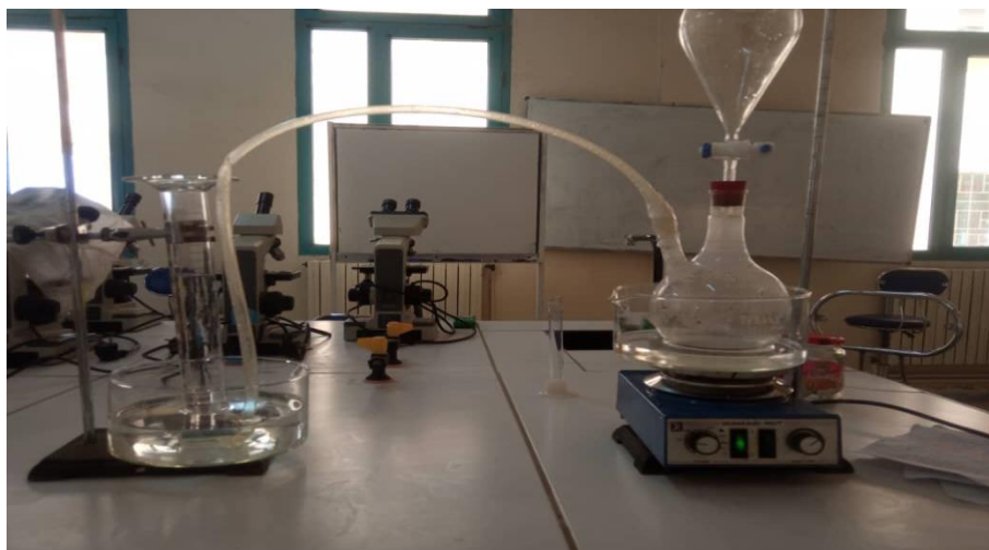
Figure 21 : Dispositif de mesure du CO 2 produit permettant la collecte du gaz (Pol,1996).
