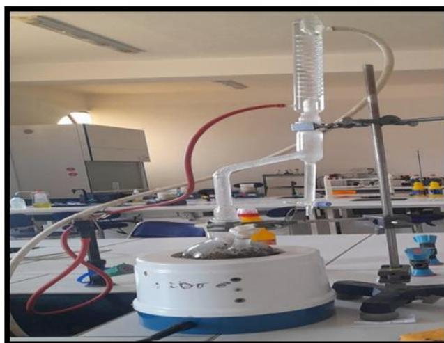
Figure 12 : Montage de l'hydrodistillateur type Clevenger (photo Farahi et Morsli, 2024)
