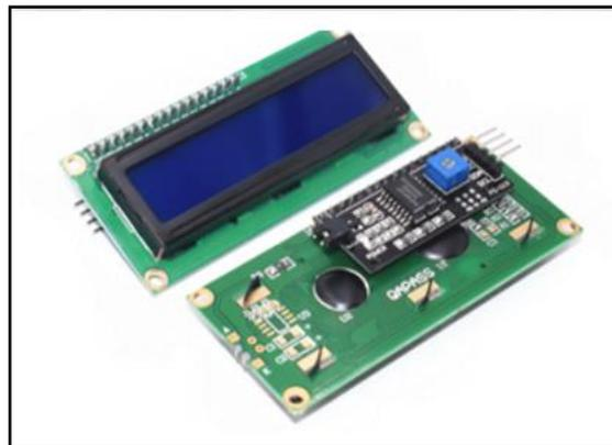
**Figure II.5:** I2C LCD display module [23].
