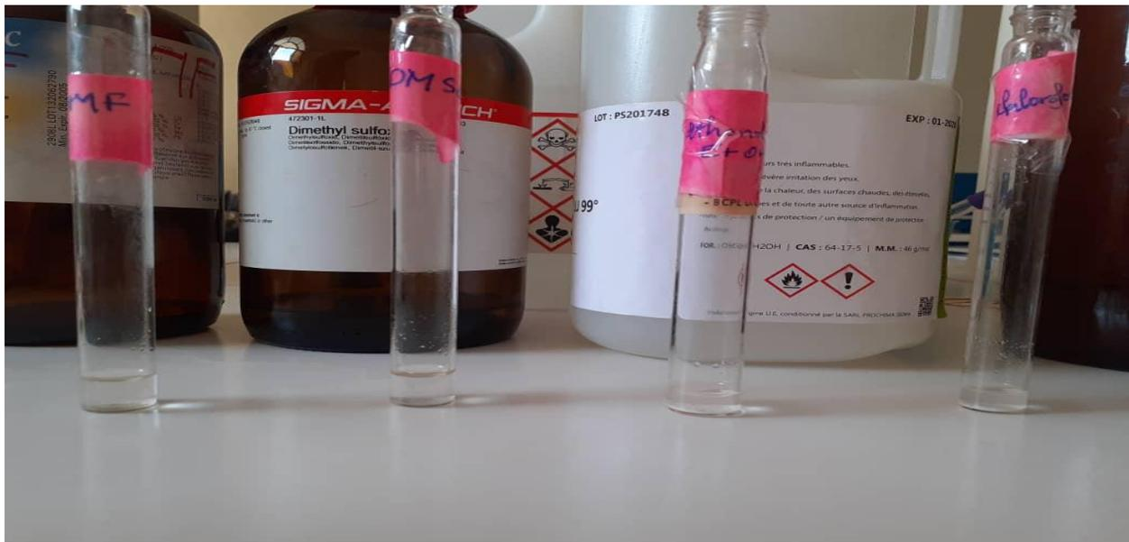
Figure I-10: Test de solubilité du TPA produit par glycolyse.
