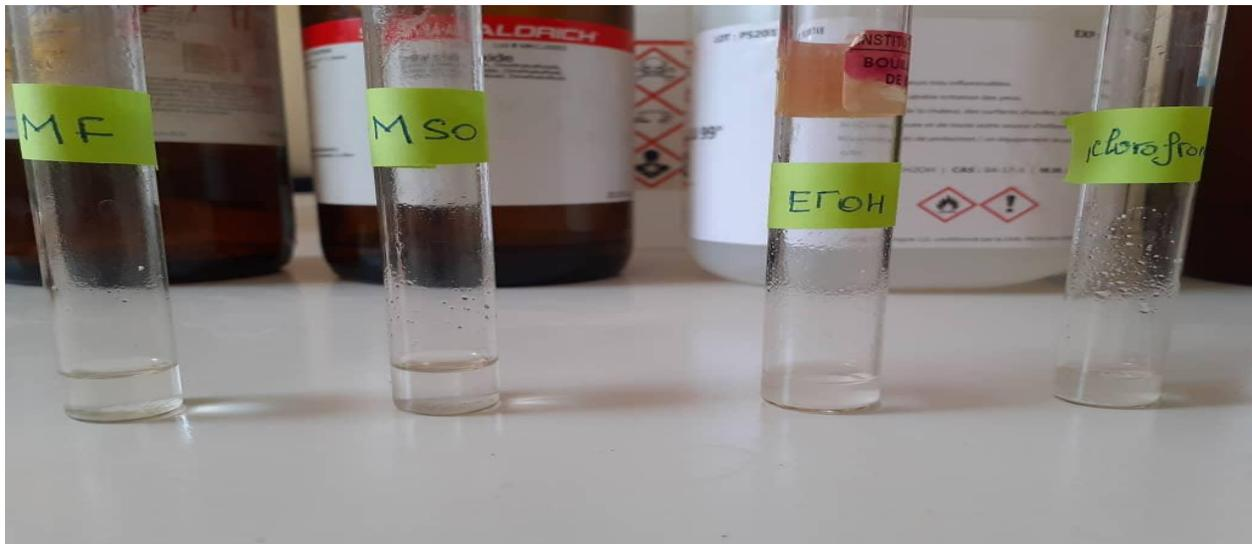
Figure I-21 : Test de solubilité du TPA produit par Hydro-alcoolyse alcaline.
