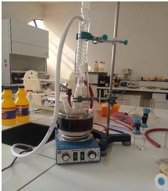
Réaction à reflux de la glycolyse
