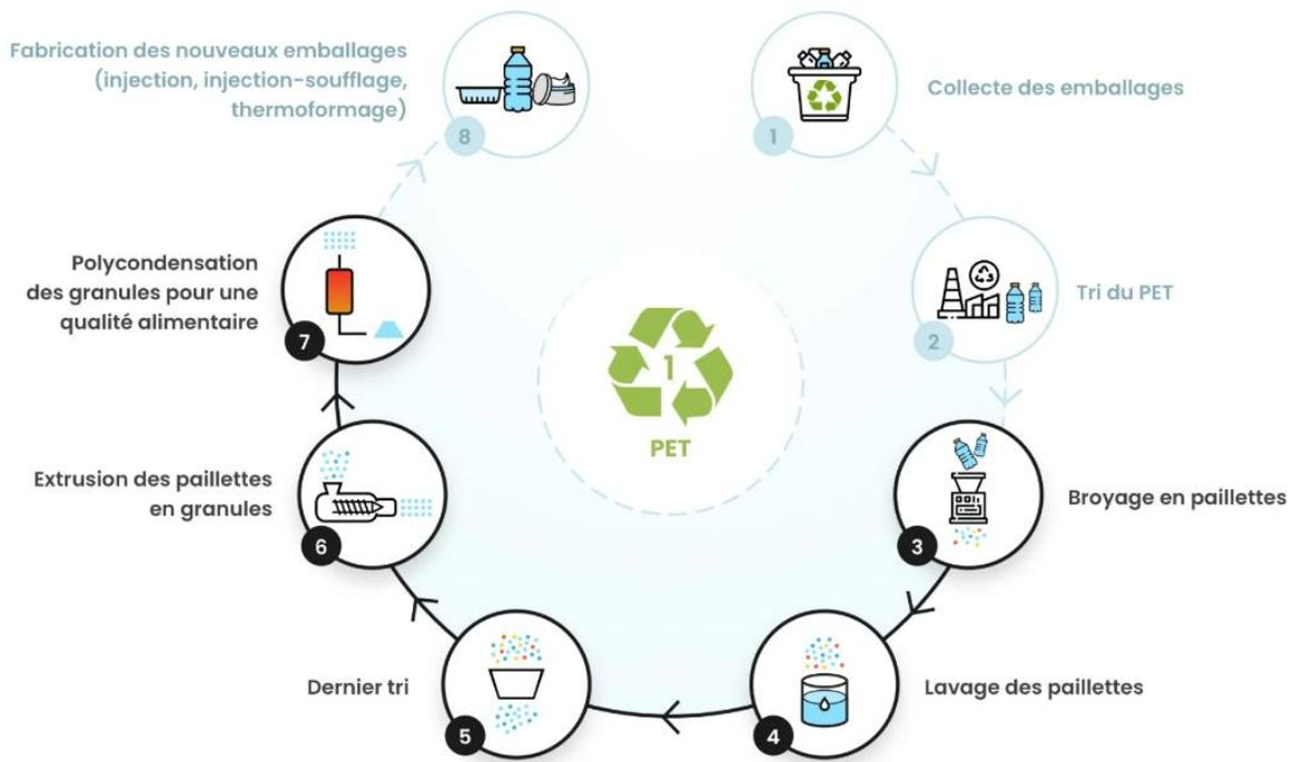
**Figure I-2:**Boucle de recyclage des bouteilles en PET[8].
