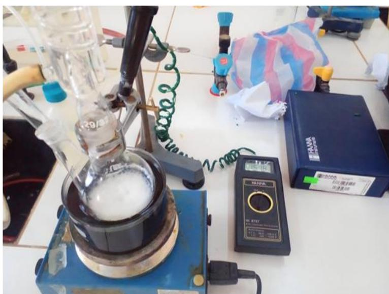
**Figure I-13 :**Réaction à reflux d'hydrolyse alcaline
