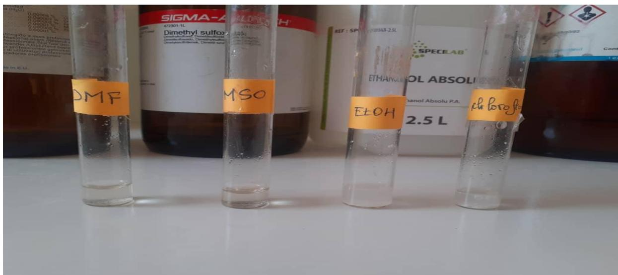
Figure I-4 : Test de solubilité du TPA par hydrolyse acide.
