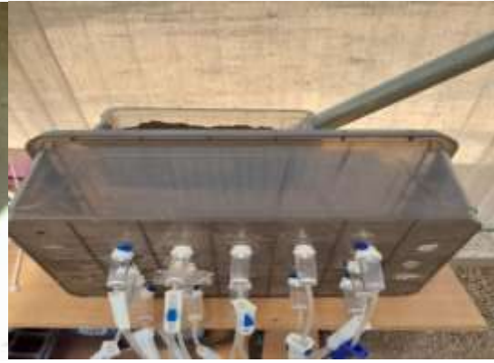
Figure 27: réservoir gouteurs(Cliché Boufadi et Ouazzani, 2024)
