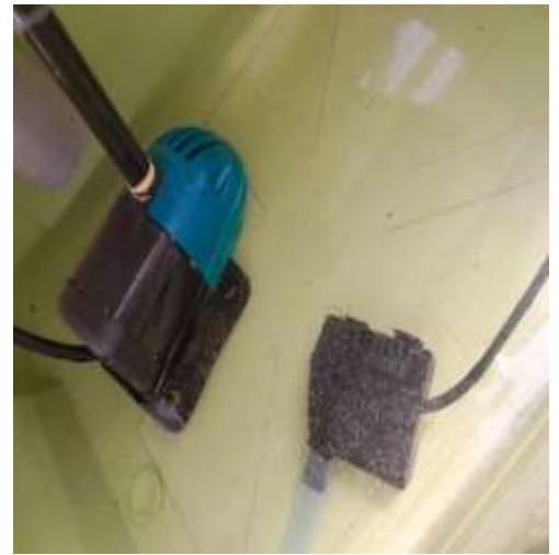
Figure 11: Pompes à eau: (Cliché Boufadi et Ouazzani, 2024)
