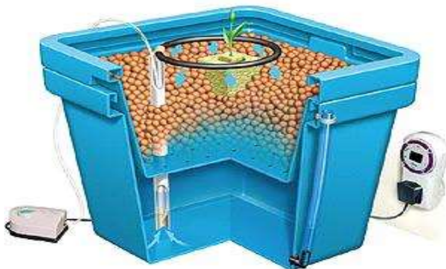
Figure 5 : Un système de goutte à goutte
