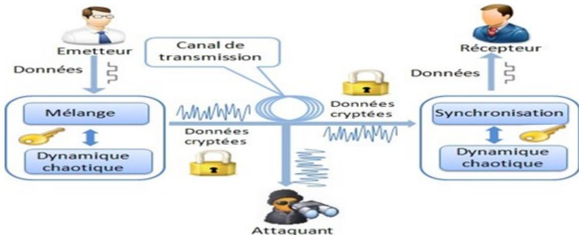
FIGURE 3.1 – Principe de Chiffrement par Chaos
