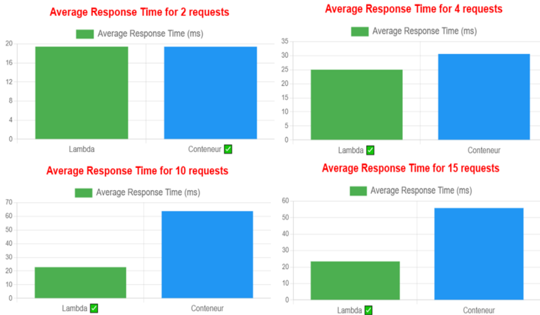
FIG. 5.9 : temps de réponse moyen dans différentes implémentations en génération d'image
