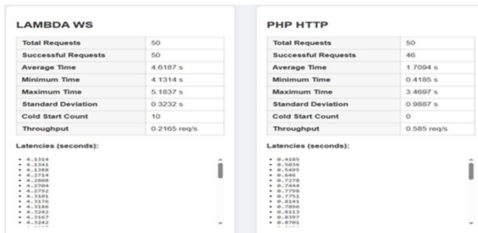
FIG. 5.11 : Comparaison après exécution entre serverless et conteneur
