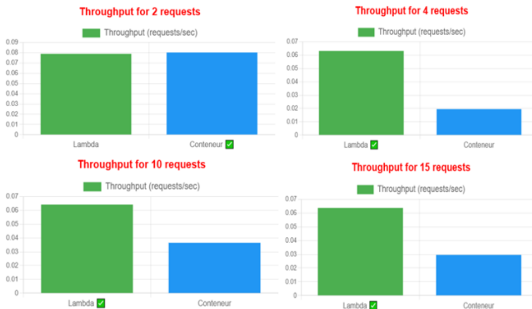
FIG. 5.8 : Débit dans différentes exécutions en génération d'image
