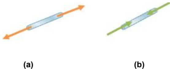
**Figure 2. 2 Efforts internes appliqués sur les barres a) Traction b) compression.**
