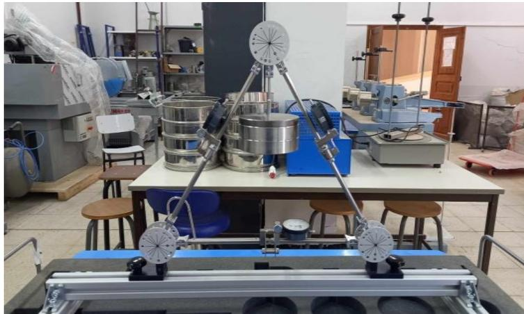
**Figure 4.11** L'appareil à la position du montage dans le cas de  $\alpha=60^\circ$ ,  $\beta=60^\circ$  et  $\gamma=60^\circ$  [12]
