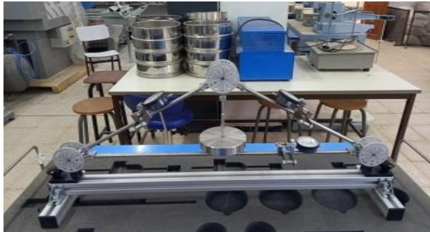
**Figure 4.15** L'appareil à la position du montage dans le cas de  $\alpha=120^\circ$ ,  $\beta=30^\circ$  et  $\gamma=30^\circ$  [12].
