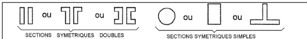
Figure 1.3. La section des barres [2]
