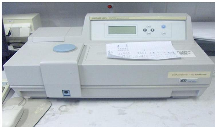
**Figure. II.2. Appareil de spectrophotométrie UV-visible**
