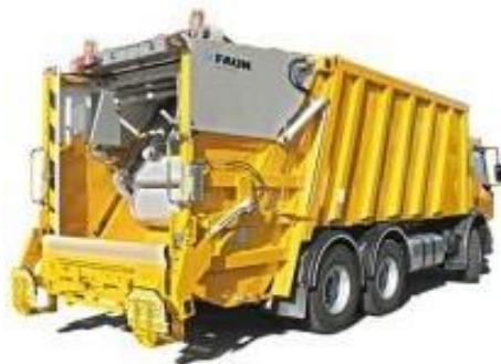
Figure 03: Camion poubelle compacteur
