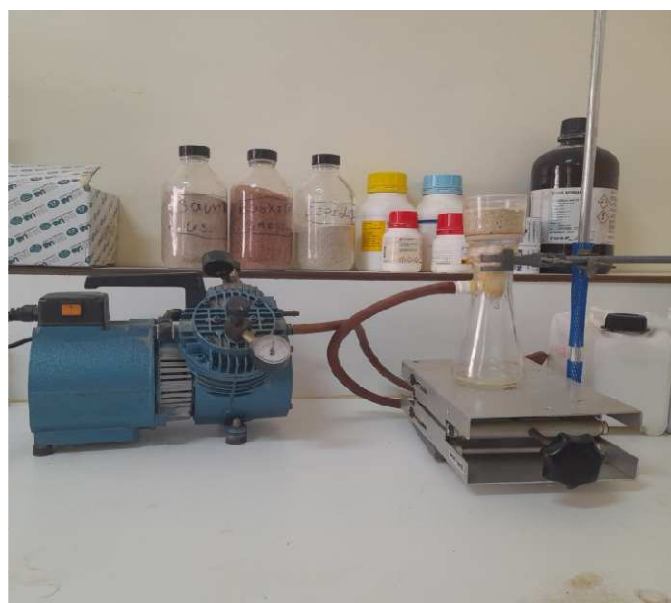
Figure. III. 24. Protocole de filtration sous vide
