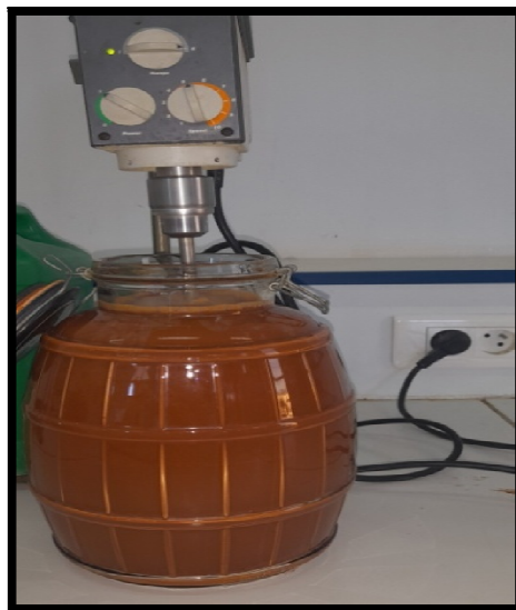
Figure. II. 14. Lavage de l'illite brute avec l'eau distillée
