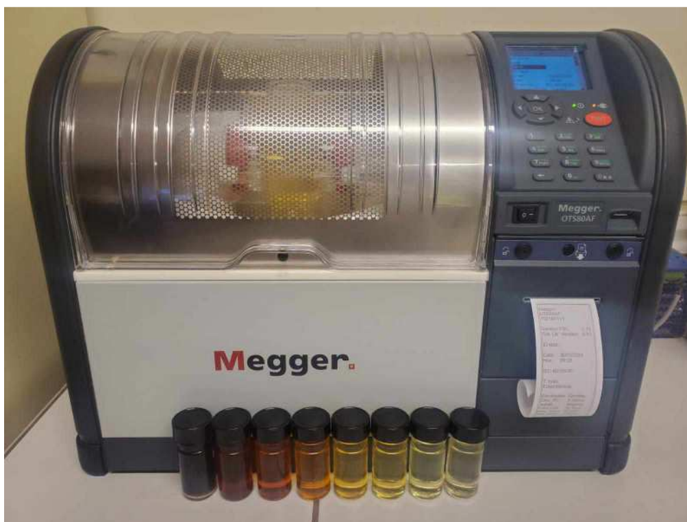
Figure.III.39. Appareil de mesure de la tension de claquage
