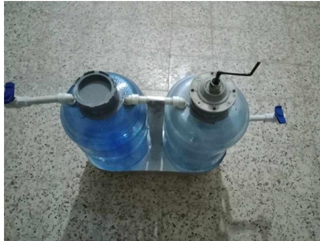
Figure 16: Installation du biodigesteur
