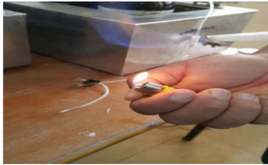
Figure 21: Test de l'inflammabilité du biogaz
