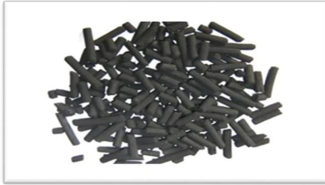
**Figure.17 :** Charbon actif en sous forme extrudée
