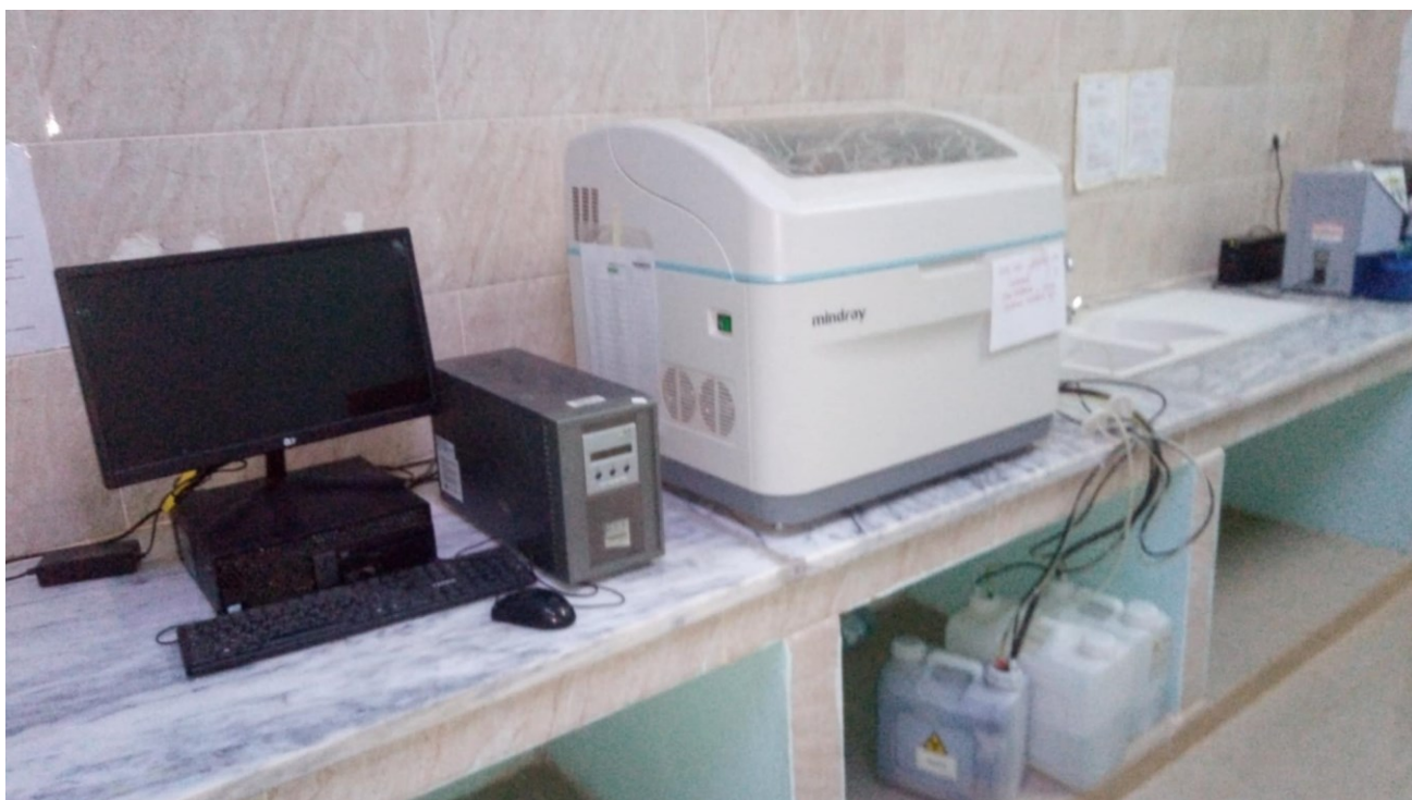
Figure 21 : Automate biochimique (mindray BS-240)
