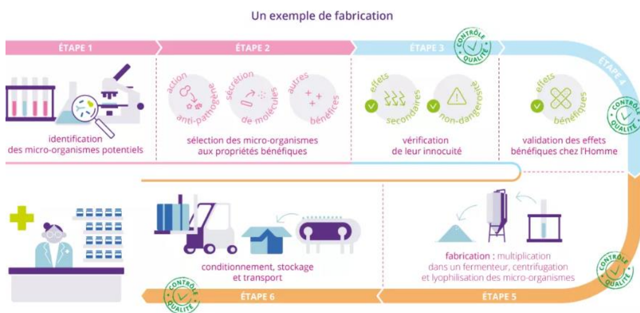
Figure 11: Exemple de chaîne de fabrication d'un probiotique (Zheng et al, 2020)
