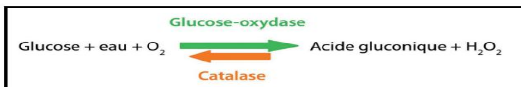
Figure 3: Réaction enzymatique produisant le H_2O_2
