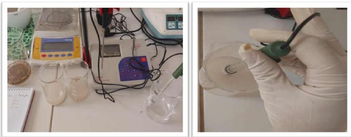
**Photo 11** : Mesure de pH ed'un échantillon par le pH mètre .
