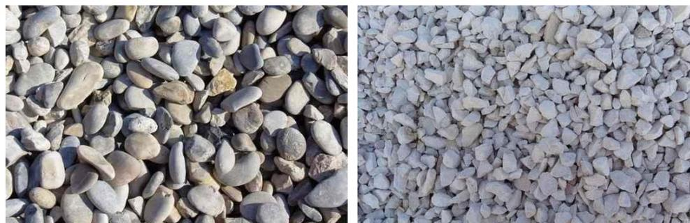
Figure 1.17 Photos des gravillons roulés (à gauche) et concassés (à droite) [26]
