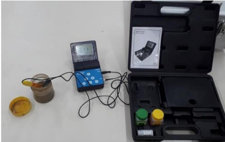
**Figure II.9:** PH mètre de mesure laboratoire de l'université de Saïda.
