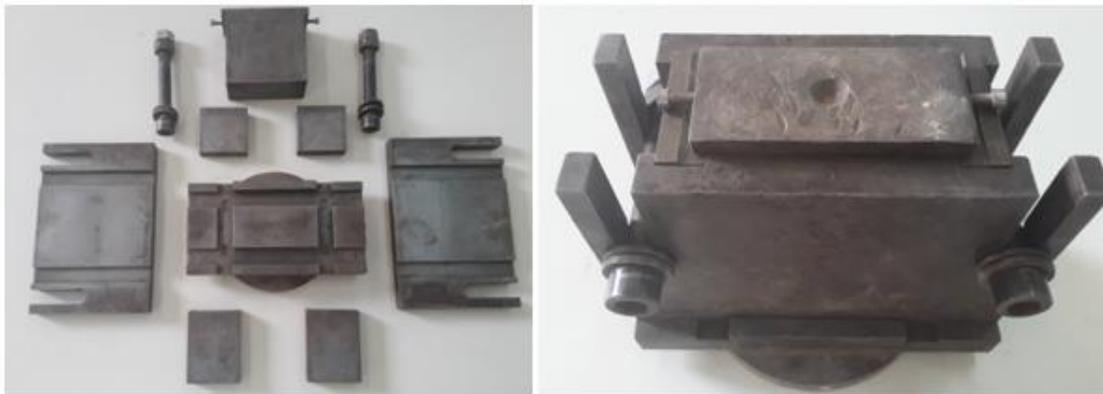
**Figure II.11: Moule de confection de l'éprouvettes laboratoire de l'université de Saïda.**
