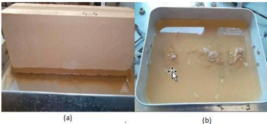
**Figure I.25: Brique après le test d'absorption d'eau par capillarité. (a) : Echantillon en contact avec l'eau ; (b) Un délitement de l'échantillon (Filament, 2017)**
