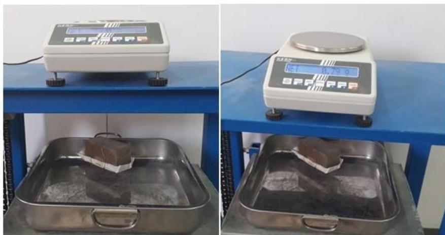
**Figure II.14: l'essai d'absorption d'eau laboratoire de l'université de Saida.**
