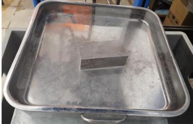
**Figure II.15: Essai d'immersion laboratoire de l'université de Saida.**
