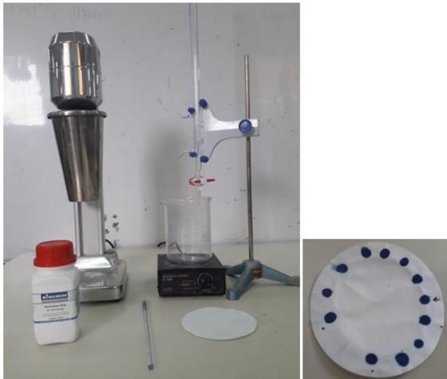
Figure II.7: Essai de bleu méthylène laboratoire de l'université de Saida.
