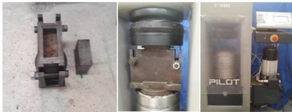
**Figure II.12: compactage statique des éprouvettes et Presse hydraulique laboratoire de l'université de Saida.**
