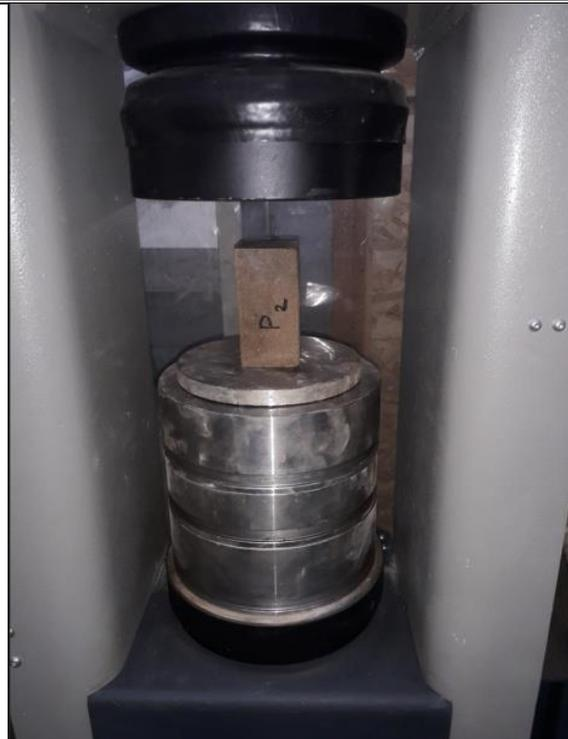
**Figure II.18: Banc d'écrasement des éprouvettes.**
