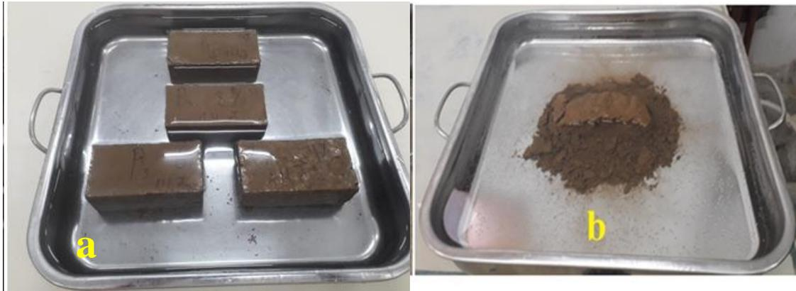
**Figure III. 17: essai d'immersion : a) mélanges avec la chaux b) argile crue.**
