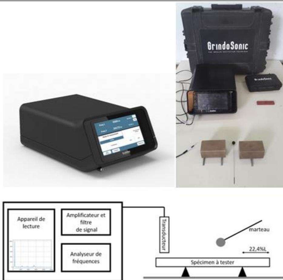
Figure II.16: Appareil Grindo Sonic MK7 et schéma du principe des mesures laboratoire de l'université de Saida.
