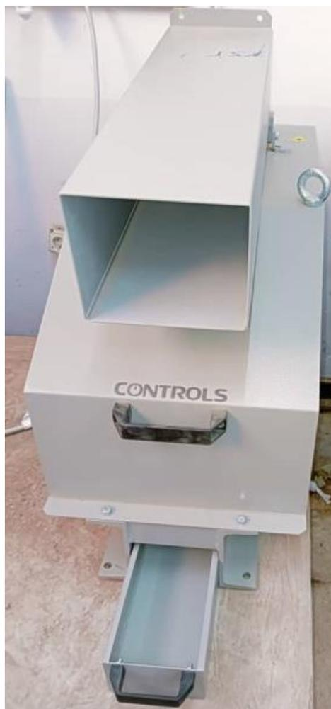
**Figure II.2: Broyeur à mâchoires laboratoire de l'université de Saida.**
