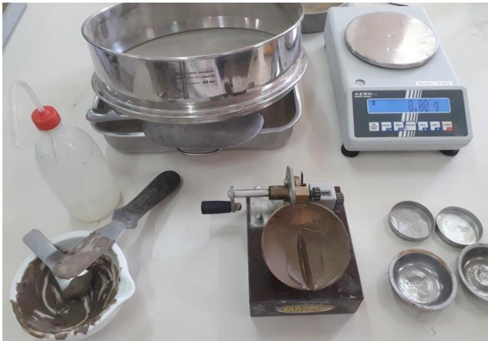
**Figure II.5: Essai de limite de liquiditélaboratoire de l'université de Saida.**
