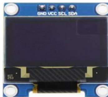
Figure 2.10 : Écran OLED SSD1306
