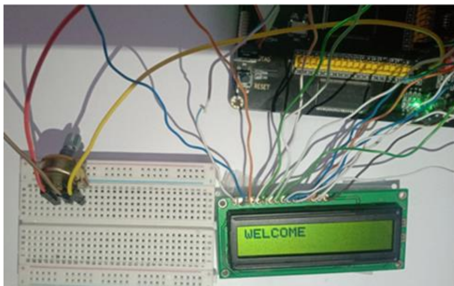
Figure III.33: Affichage du message « WELCOME » sur l'afficheur LCD 16x2.
