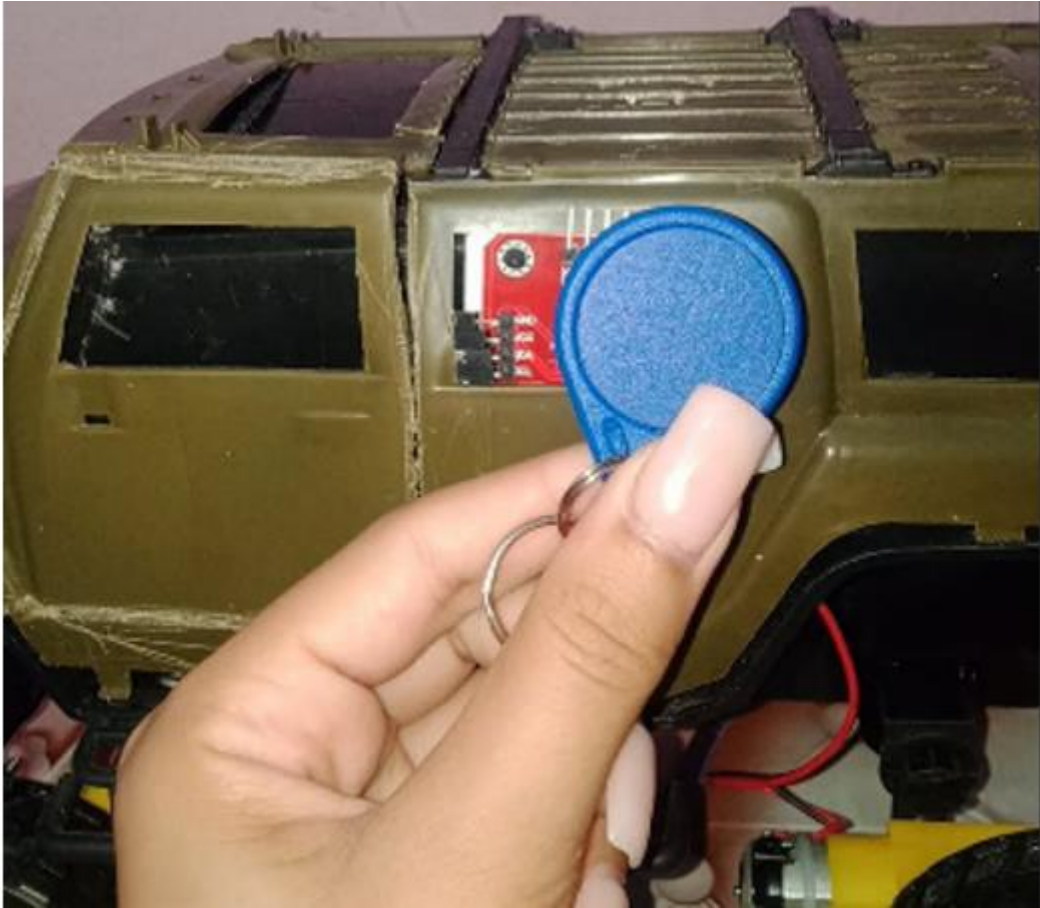
Figure III.61 : Refus d'accès – Tag RFID non autorisé, porte du véhicule fermée.
