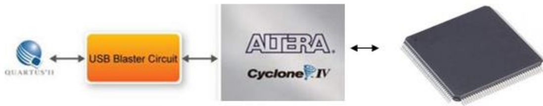
Figure I.12 : Programmation d'un périphérique de configuration série avec une solution de chargeur flash série [I.15].
