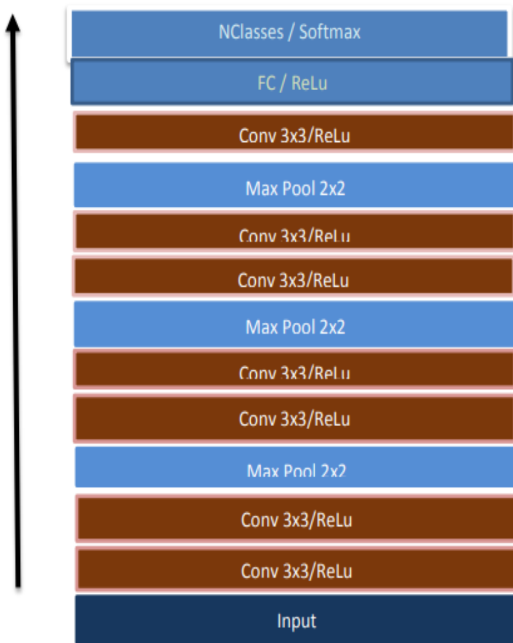
Figure 2.1 : architecture générale d'un CNN
