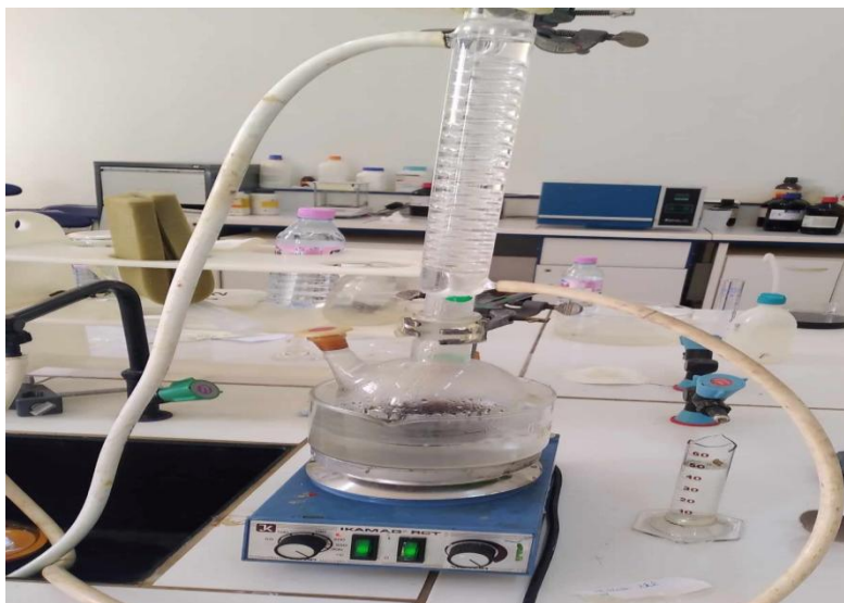
Figure22:Montage de chauffage à reflux.
