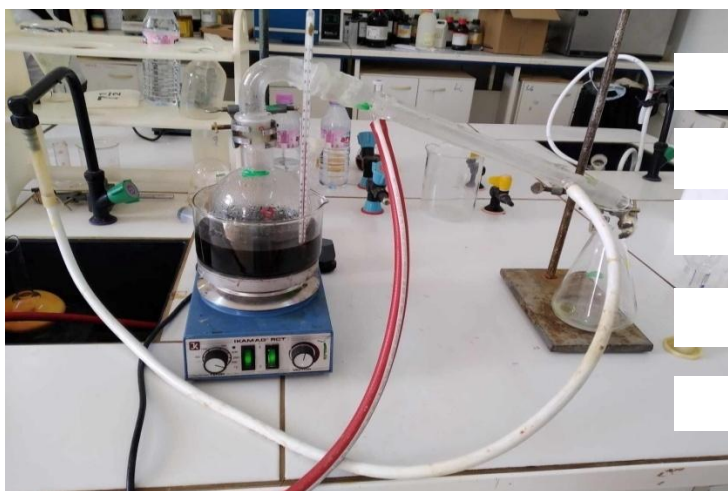
Figure23 :Montage d'hydro distillation.
