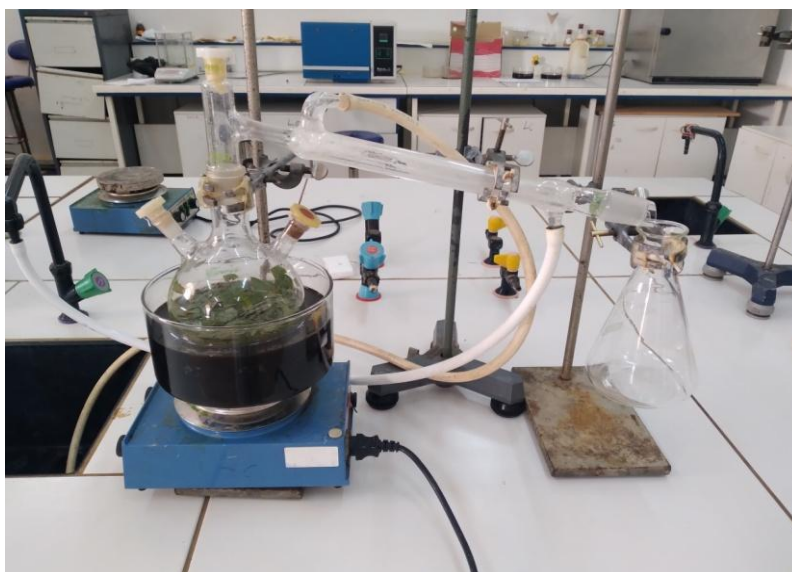
Figure29 : Montage d'extraction d'huile essentielle de l'eucalyptus
