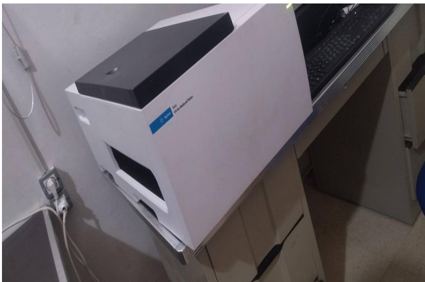
Figure II.7. Spectrophotomètre UV-Visible utilise lors de la réalisation de cette étude
