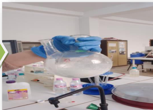
Refroidissement du mélange réactionnel à l'air libre
