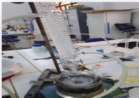
Réaction à reflux d'hydro alcoolyse alcaline
