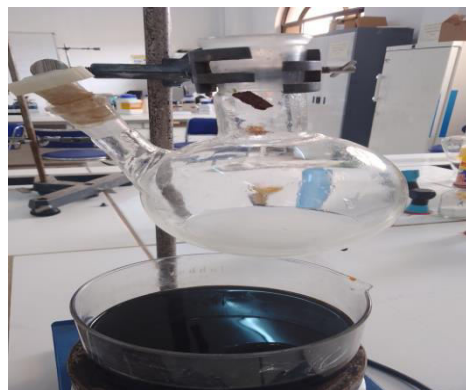
Refroidissement du Mélange réactionnel à l'air libre
