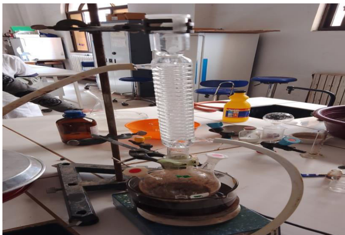
Réaction à reflux de l'Aminolyse (catalyseur hétérogène)
