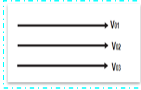
Figure (2. 21) : Système homopolaire
