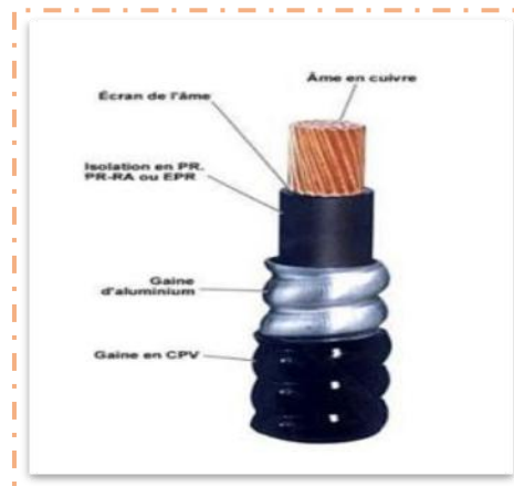
Figure (1.14): Coupe d'un câble souterrain.
