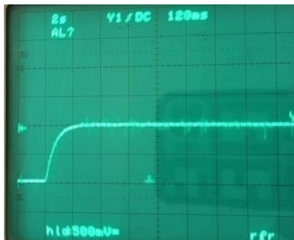
Figure (IV.35) : La courbe de la vitesse du MCC en charge pour \alpha = 0,99 .
