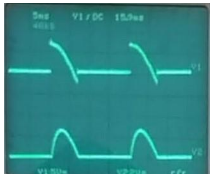
Figure (III.30) : Tension de sortie (CH1) et courant de sortie (CH2) avec charge inductive pour \psi = \pi/4
