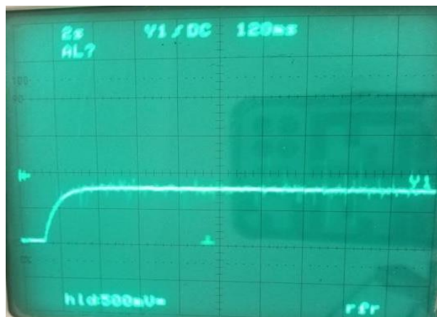
Figure (IV.34) : La courbe de la vitesse du MCC en charge pour \alpha = 0,6 .
