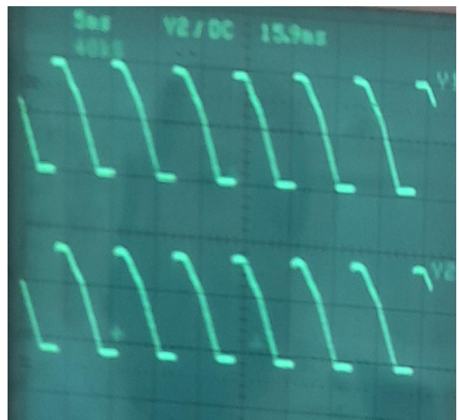
Figure (III.57) : Tension de sortie et courant de sortie charge résistive pour \psi = 0 .
