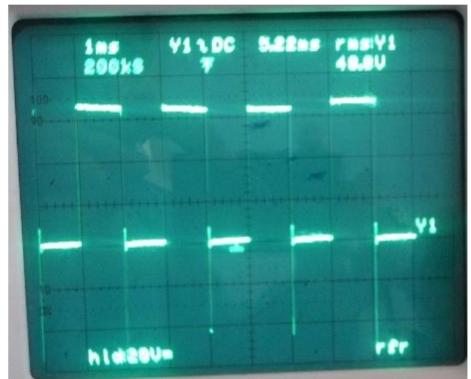
Figure (IV.19) : Signal PWM à fréquence 500 Hz et rapport cyclique 0.5-charge R.
