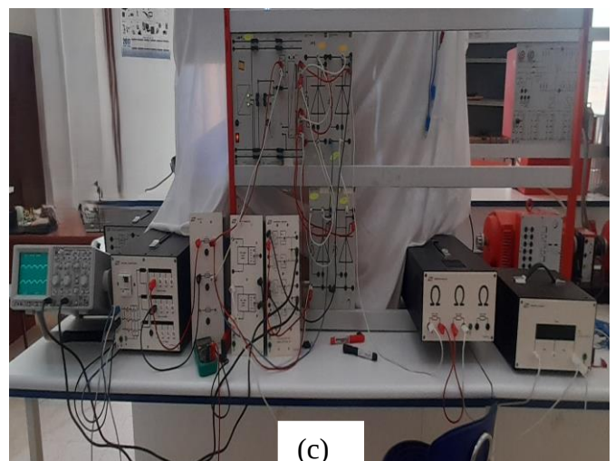
Figure (III.38) : Montage double alternance commandé avec charge inductive, (a) théorique, (b) simulation, (c) pratique.
