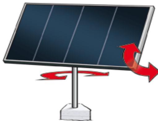
Figure II.8 : Panneau solaire avec système de poursuite bi-axiale.
