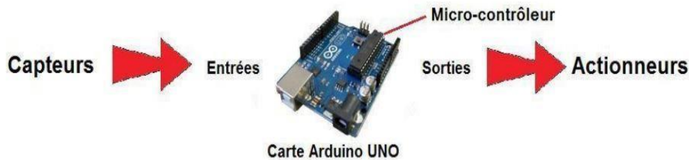
Figure I.2 : La carte Arduino avec ses capteurs en entrée et ses actionneurs en sortie.
