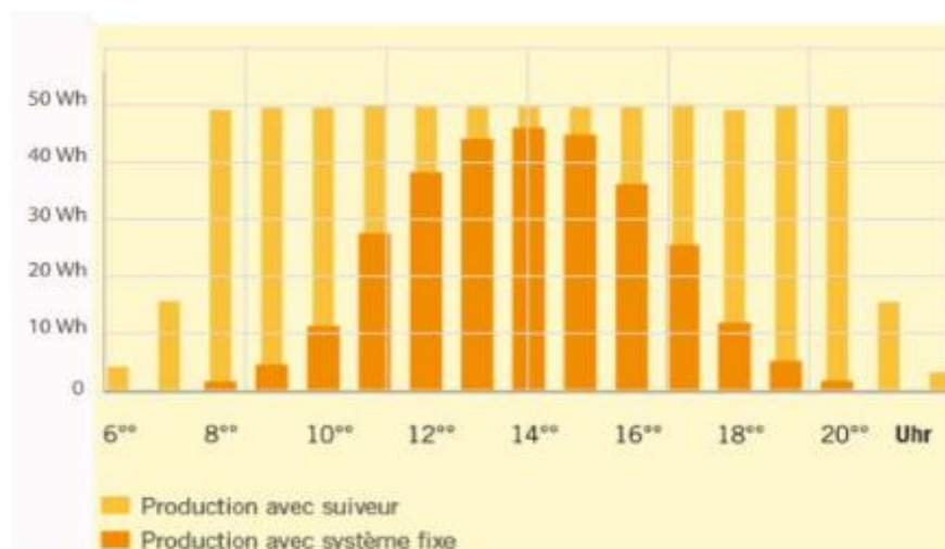
Figure I.15 : Diagramme de comparaison entre la production avec suiveur et la production avec système.
