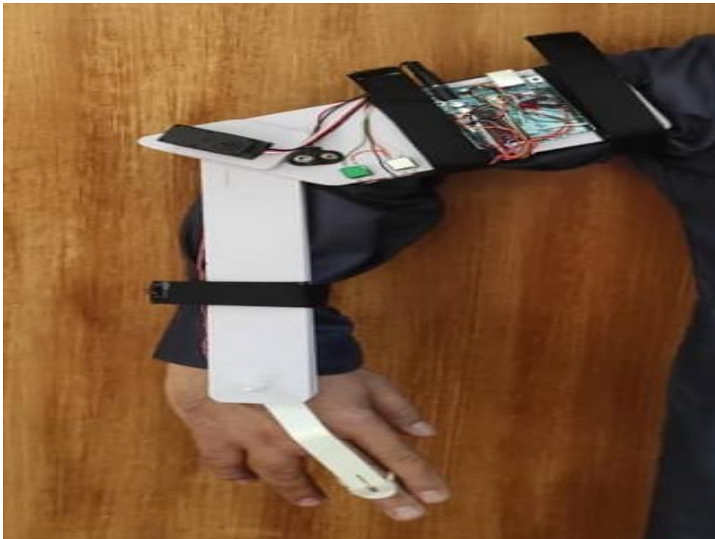
Figure.III.13. : Mouvement du bras lors de l'abaissement du poignet
