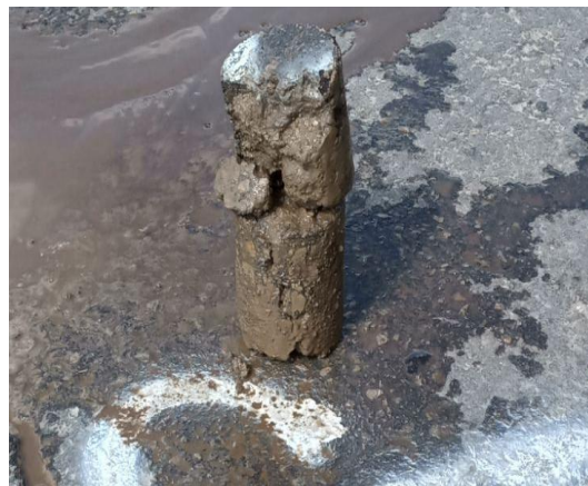
Carotte N°01 au PK 75+000 sur un faïençage à maille large sens vers Tiaret.
