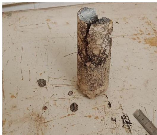
Carotte N°02 au PK 75+000 sur un faïençage à maille large sens vers Saïda.
