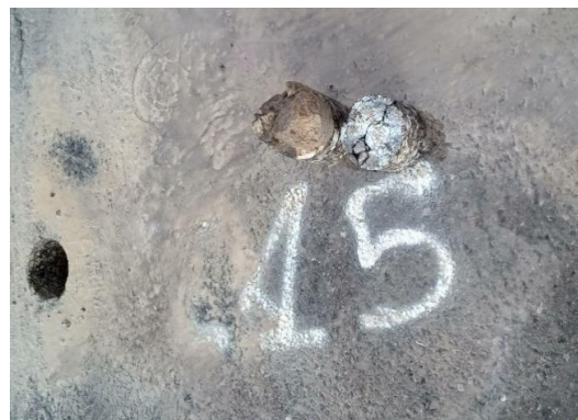
Carotte N°15 PK 87+000 sur une fissure longitudinale.
