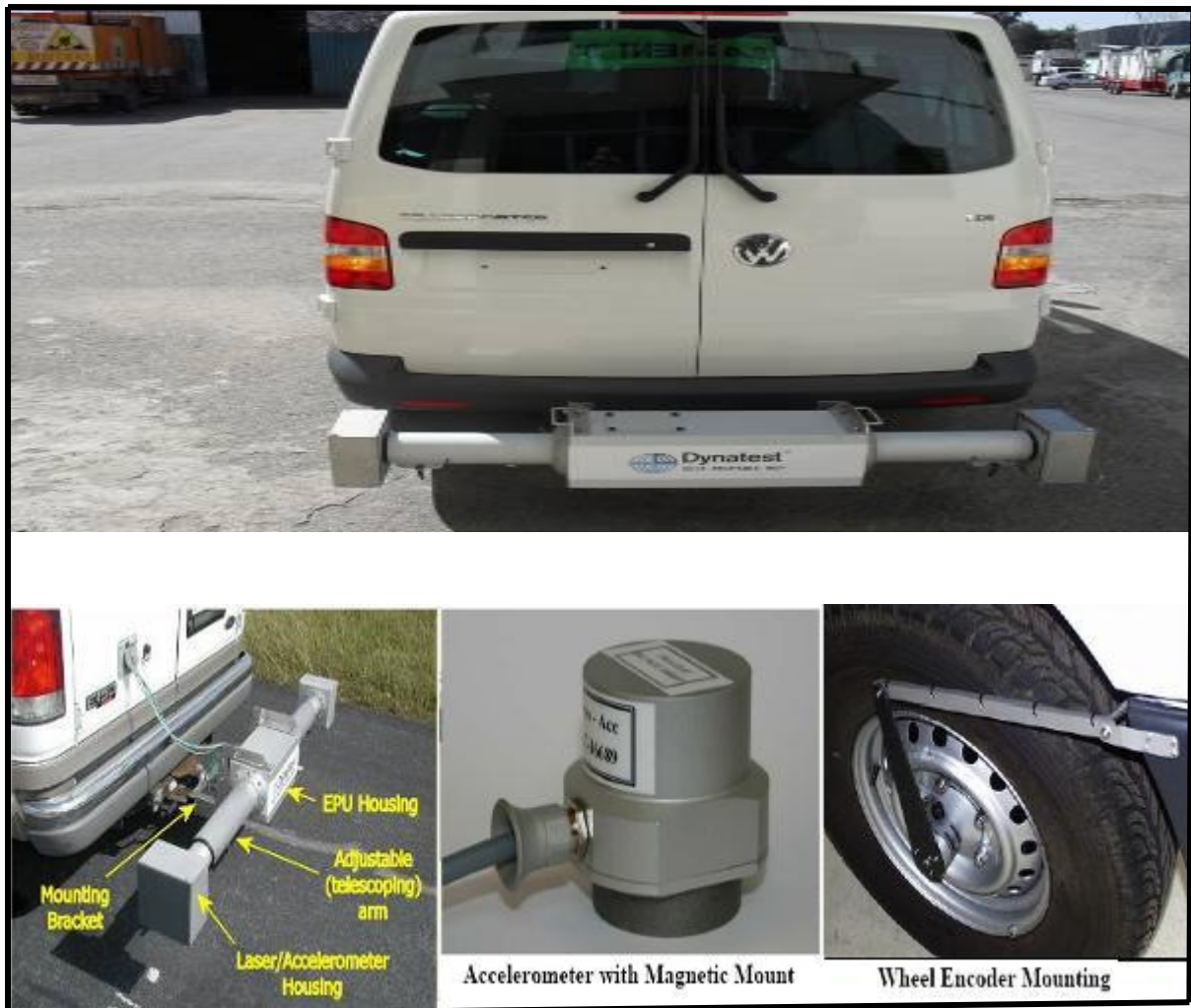
Figure III.20 : Road Surface Profilomètre RSP 5051 MARK IV du CTTT [24].
