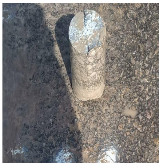
Carotte N°11 au PK 82+000 sur une fissure transversale.
