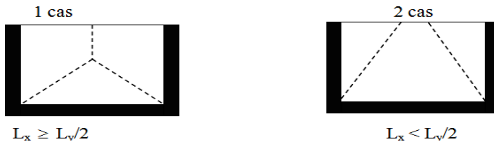
Figure 3.6: Ligne de rupture d'une dalle sur trois appuis.
