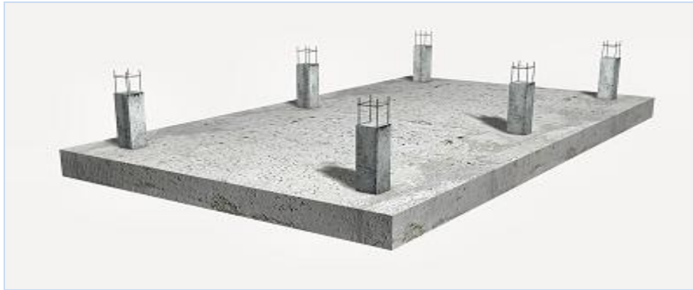
Figure III. VII. 2 Schéma d'un radier général.
