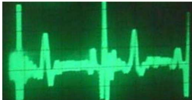
Fig. I.22: Signal ECG après amplification
