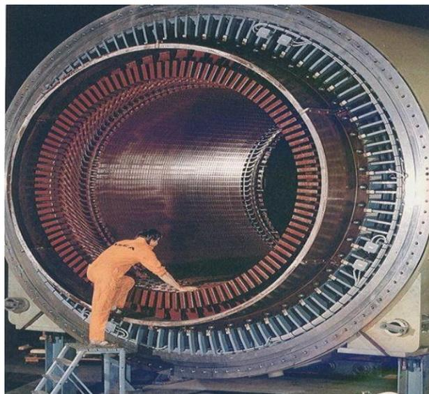
Fig. I.2 : Stator d'un alternateur
