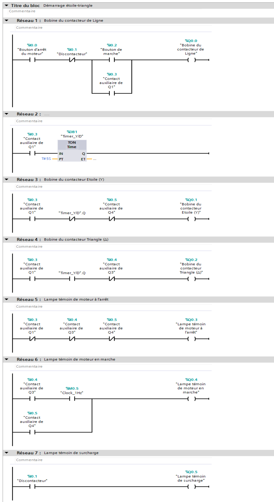
Fig III.66 Démarrage étoile-triangle (ladder)
