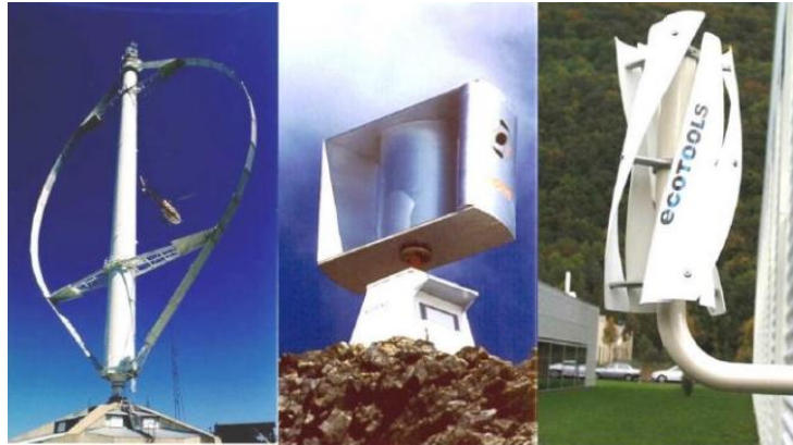
Figure I.32 : Les éoliennes à axe vertical
