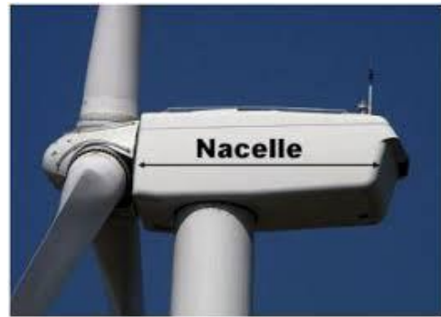
Figure I.37 : la nacelle d'une éolienne
